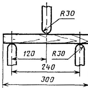
4.2. Образец нагружают равномерно с постоянной скоростью нагружения или постоянной скоростью перемещения активного захвата машины. Скорость должна быть такой, чтобы образец разрушился через  $(1,5 \pm 0,5)$  мин после начала нагружения.
